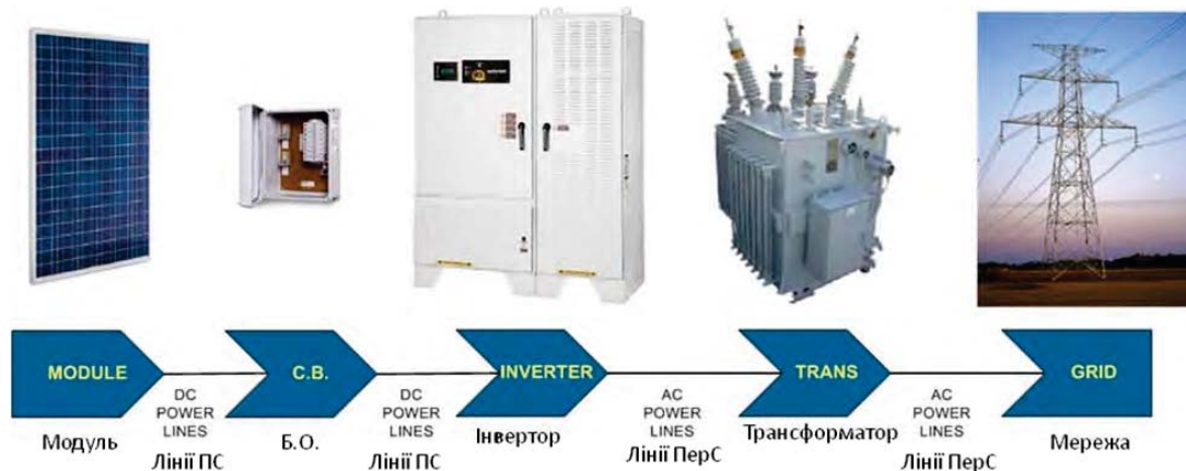
Рисунок 3-2. Типові компоненти ФГ-установки
