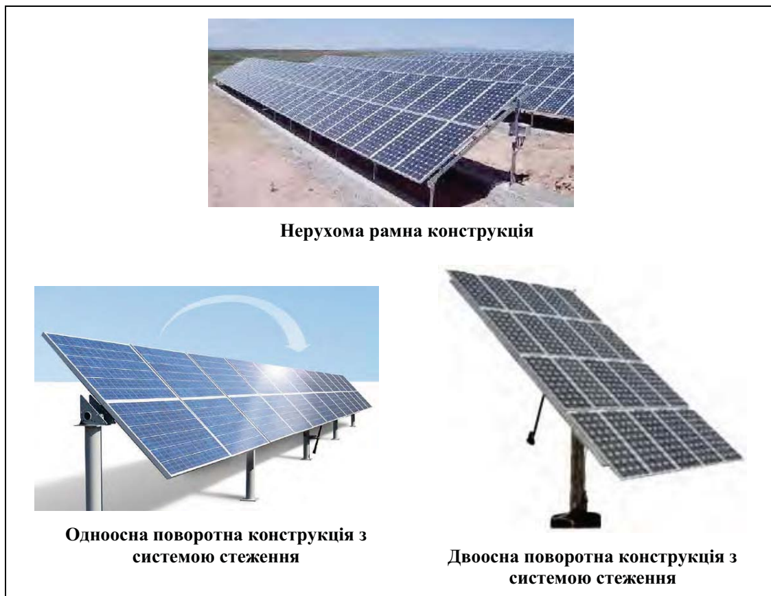
Рисунок 3-3. Рамні конструкції сонячних фотогальванічних установок
